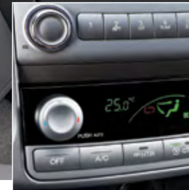
Климат-контроль поддерживает в салоне желаемую температуру, при этом циркуляция воздушных потоков происходит практически бесшумно.
