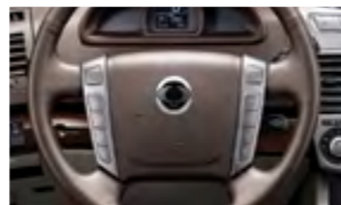
Переключение передач и управление аудио на рулевом колесе.
