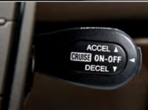
Круиз-контроль обеспечивает поддержание постоянной скорости автомобиля при различных дорожных условиях.
