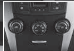
Панель управления обогревателем / системой кондиционирования воздуха
